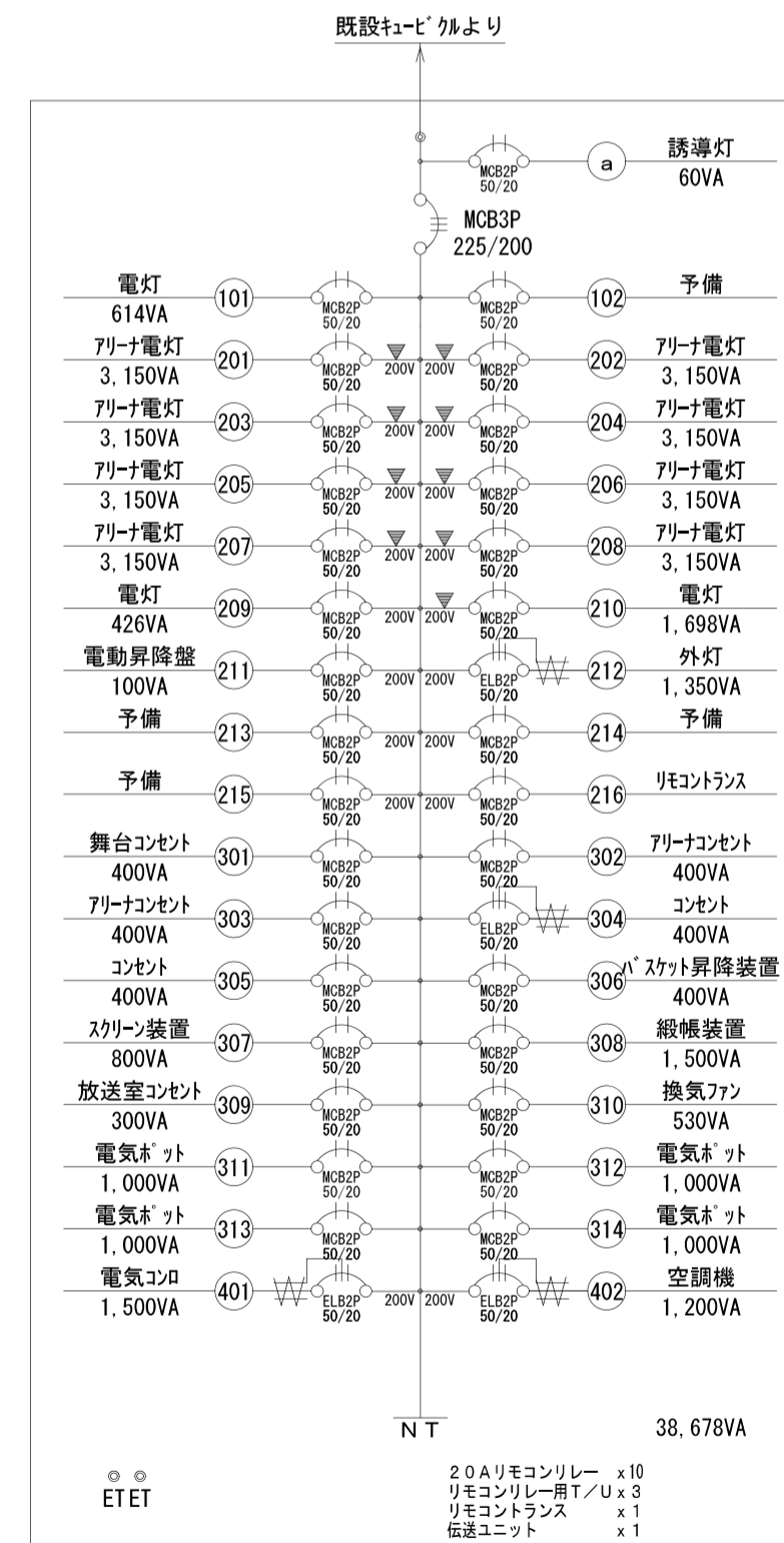
【改修前】 既設電灯盤 (L-TA)
